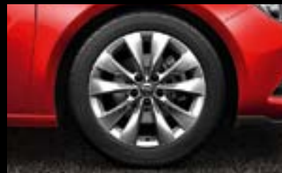
Točak od lake legure, 7.5 J x 18", dizajn sa više kraka, pneumatici 235/50 R 18 (RQJ 3 ). Standardno za Sport i Active.
