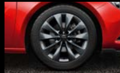
Točak od lake legure, 7.5 J x 18", dizajn sa više kraka i visokim titanijumskim sjajem, pneumatici 235/50 R 18 (SGE). Ekskluzivna opcija za Active.
