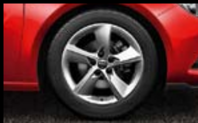
Točak od lake legure, 7.5 J x 18", dizajn sa 5 kraka, pneumatici 235/50 R 18 (RSZ 3 ). Standardno za BiTurbo.
