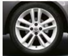
Točak od lake legure, 7 J x 17, dizajn sa 5 duplih kraka, Kazablanka bela, pneumatici 215/45 R 17 (QV3 i 40P).
