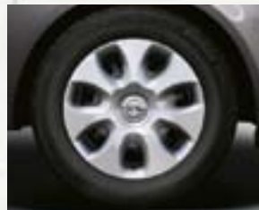
Čelični točak uključujući naplatak, 6 J x 15, dizajn sa 7 kraka, pneumatici 185/65 R 15 (QV7).
