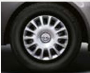
Čelični točak uključujući naplatak, 5.5 J x 14, dizajn sa 14 kraka, pneumatici 185/70 R 14 (PA8).
