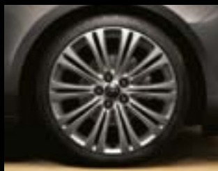
Točak od lake legure, 8 J x 19", dizajn sa više kraka u boji Dark Titan, pneumatici 235/40 R 19 (PZU 5 ).
