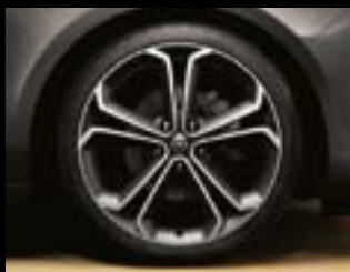
Točak od lake legure, 8 J x 19", dizajn sa 5 kraka u dve boje, pneumatici 235/40 R 19 (PZT 5 ).
